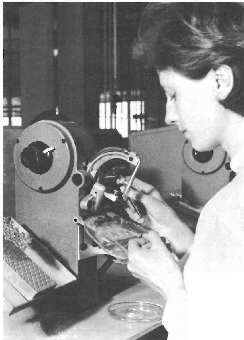
Saldatrice a temporizzatore elettronico
