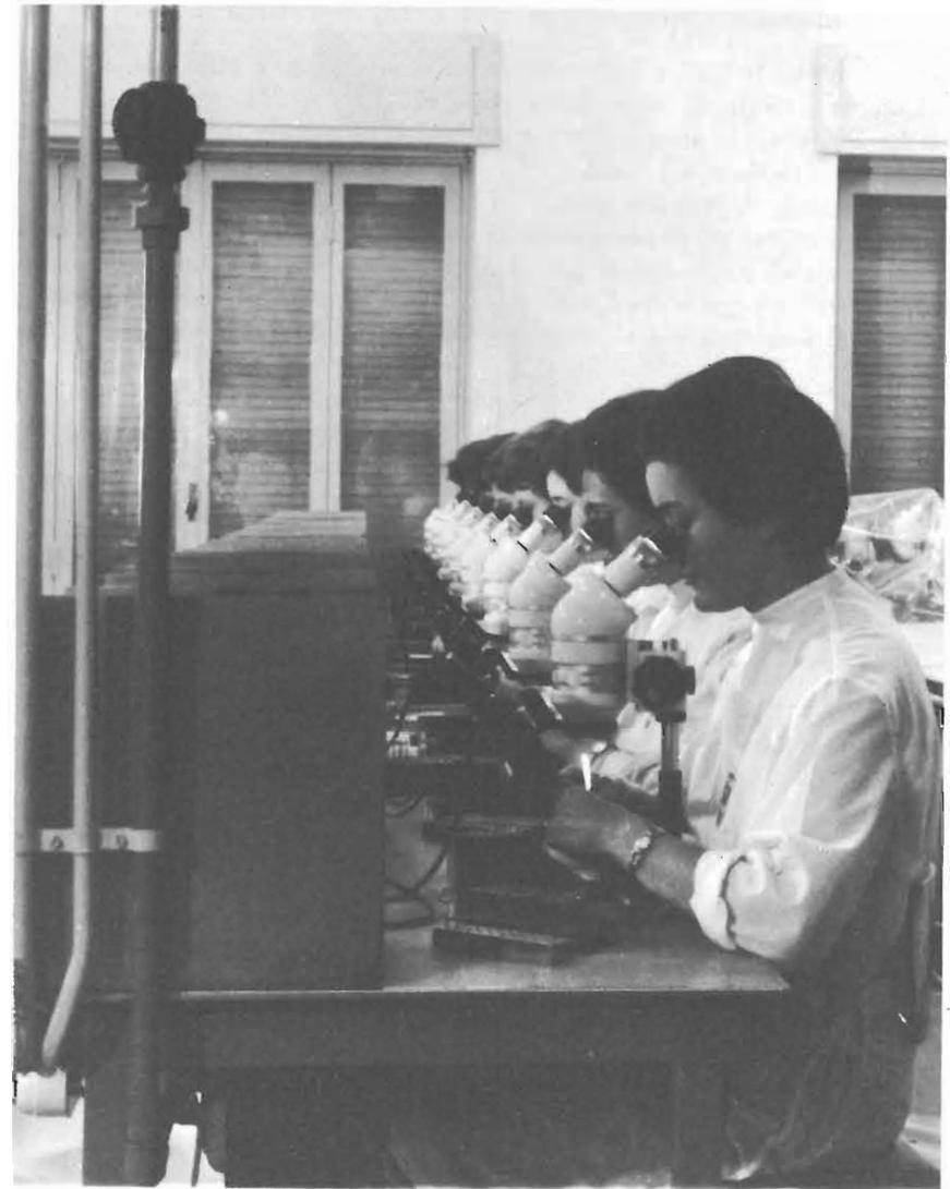
Posizionatura di transistor per alta frequenza
