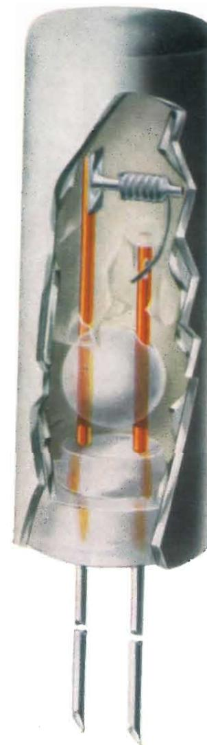
Diodo Zener al silicio ottenuto con il processo di lega.
