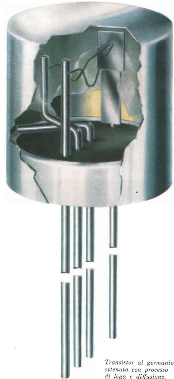
Transistor al germanio ottenuto con processo di lega e diffusione.
