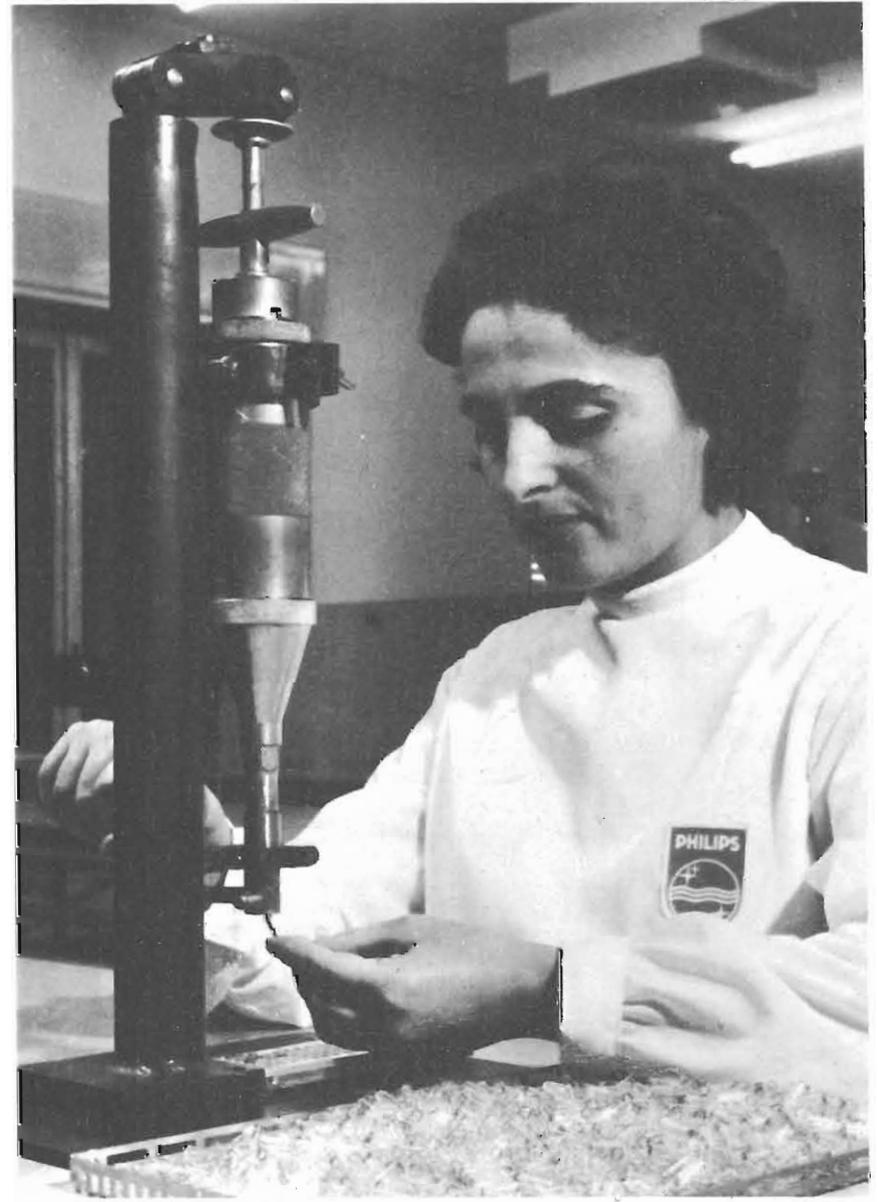
Preparazione dei palloncini di vetro per un determinato tipo di transistor
